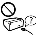
Kizárólag a nyomtatóhoz mellékelt tápkábelt használja. Másfajta kábel használata tüzet vagy áramütést okozhat. Ne használja a kábelt más készülékhez.
