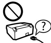
Utilizzare solo il cavo di alimentazione fornito con la stampante. L'utilizzo di altri cavi potrebbe causare un incendio o una scossa elettrica. Non utilizzare il cavo con altre apparecchiature.
