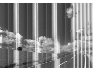
Als u in uw afdrukken ontbrekende segmenten of onderbroken lijnen constateert, drukt u een sputtkanaaltjespatroon af om te controleren of de sputtkanaaljes van de printkop verstoppt zijn. Raadpleeg de *Gebruikershandleiding* voor meer informatie.
