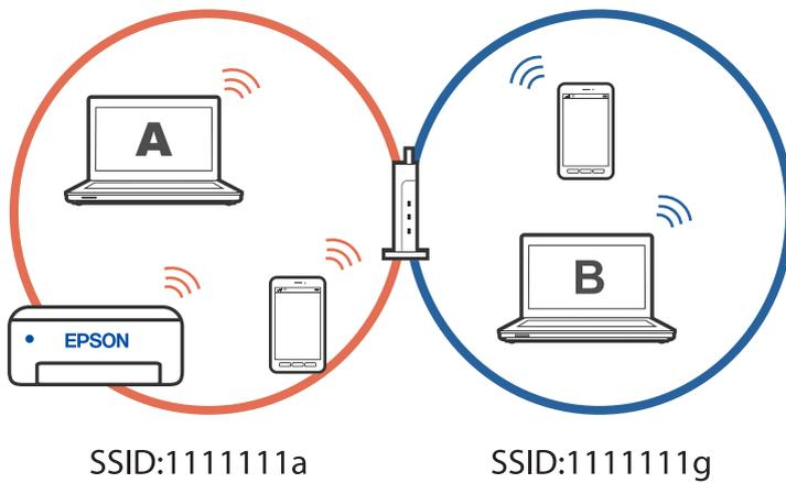
Wenn Sie überdies mit der Einrichtung des Druckers von Computer B in der oben gezeigten Konfiguration beginnen, wird der Drucker im Netzwerk von Computer B eingerichtet, wodurch Computer B, nicht aber Computer A drucken kann.
