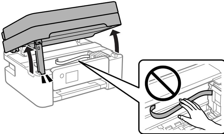
3. Überprüfen Sie, ob der durchsichtige Film verschmiert ist. Verschmierungen lassen sich mit einem Licht einfacher sehen.
