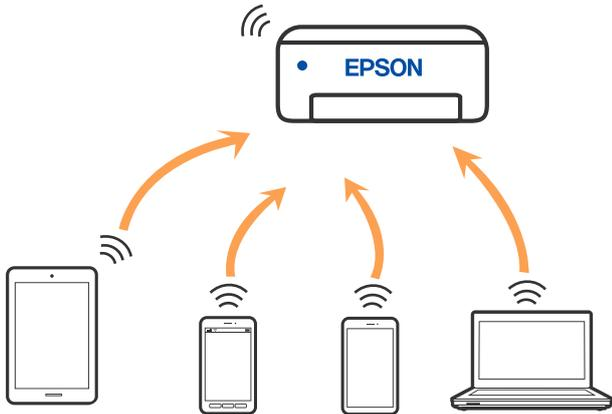
Der Drucker kann über Wi-Fi und Wi-Fi Direct (Einfacher AP) gleichzeitig verbunden werden. Wenn Sie jedoch in Wi-Fi Direct (Einfacher AP) eine Netzwerkverbindung starten, wenn der Drucker über Wi-Fi verbunden ist, wird die Wi-Fi-Verbindung vorübergehend getrennt.
