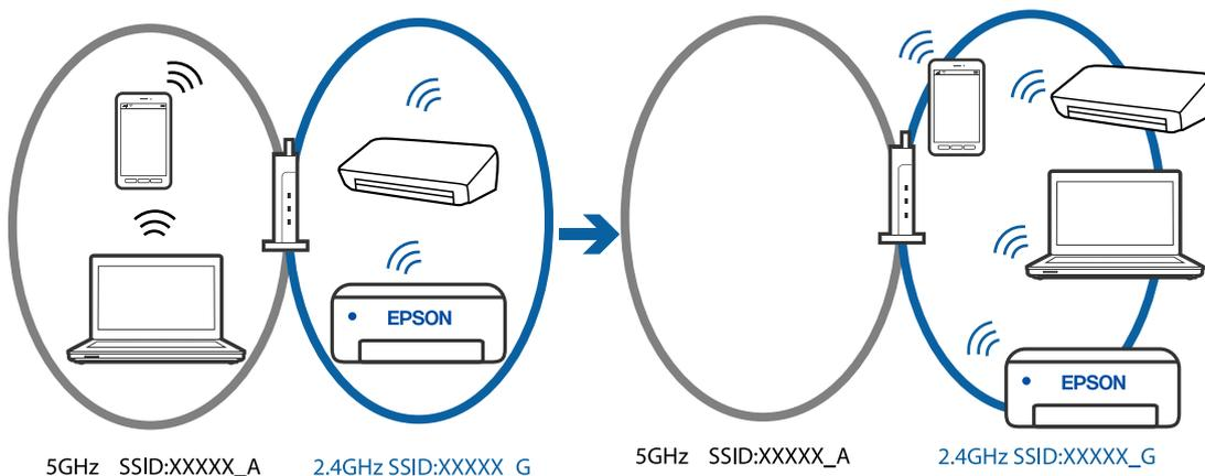
Verbinden Sie den Computer oder das Smart-Gerät mit der gleichen SSID wie den Drucker.
