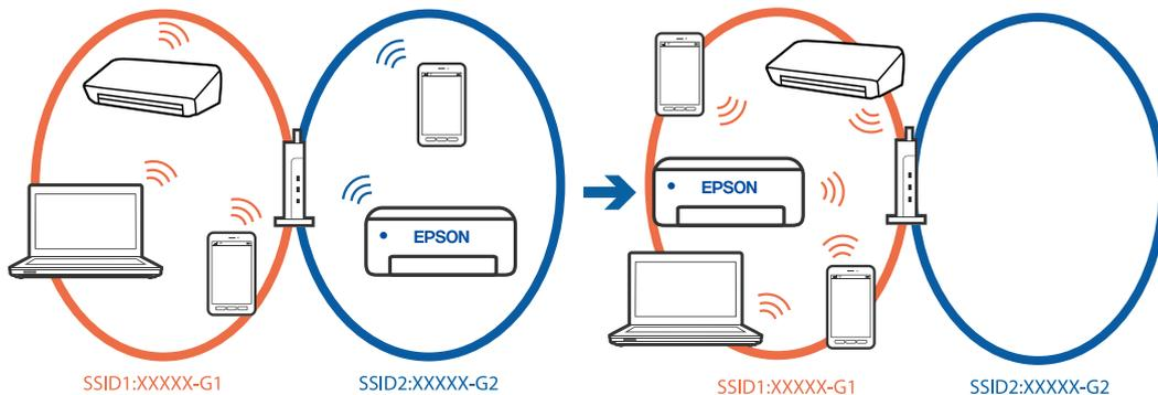
Beispiel für eine Verbindung zu SSIDs mit einem anderen Frequenzbereich
