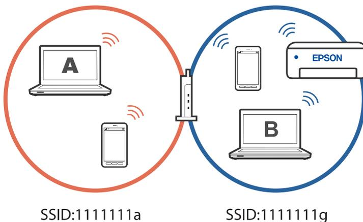
Damit dies nicht geschieht, starten Sie das Installationsprogramm auf dem Computer, der mit demselben Netzwerk wie der Drucker verbunden ist, wenn Sie einen vernetzten Drucker über einen zweiten Computer einrichten möchten. Wenn der Drucker in demselben Netzwerk gefunden wird, wird der Drucker nicht neu für das Netzwerk konfiguriert, sondern einsatzbereit gemacht.
