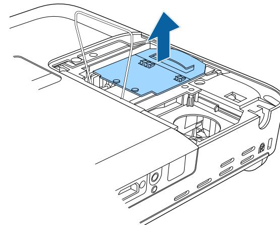
**5** Поднимите фиксирующую пружину лампы.
