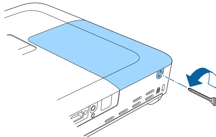
**4** Сдвиньте крышку лампы и снимите ее.
