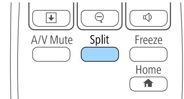
Выбранный в настоящий момент источник входного сигнала проецируется на левую часть экрана.
