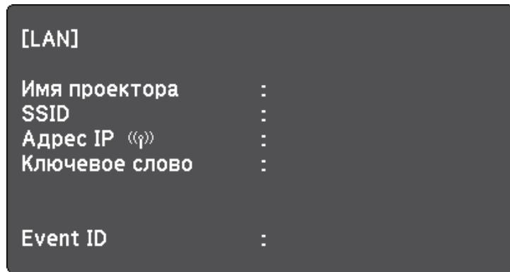
После завершения настройки беспроводного соединения проектора необходимо выбрать беспроводную сеть на компьютере. Затем запустите сетевую программу, чтобы передать изображения на свой проектор по беспроводной сети.
