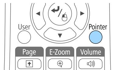
**2** Для перемещения указателя по экрану используйте кнопки со стрелками. Для перемещения указателя по диагонали одновременно нажмите любую пару смежных кнопок со стрелками.
