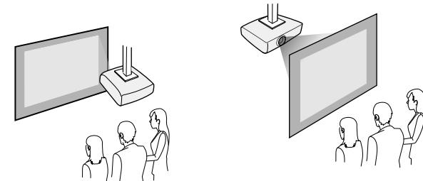
Проверьте, что выбран параметр **Проектирование** в меню **Расширен.** проектора в зависимости от используемого способа установки.
