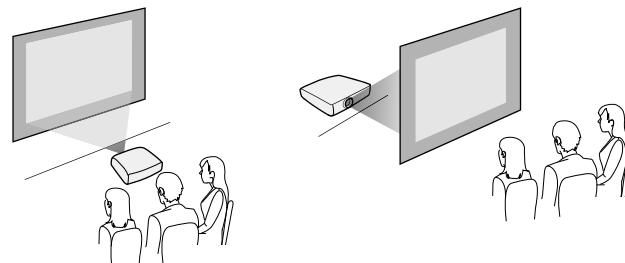
Спереди на потолке / Сзади на потолке
