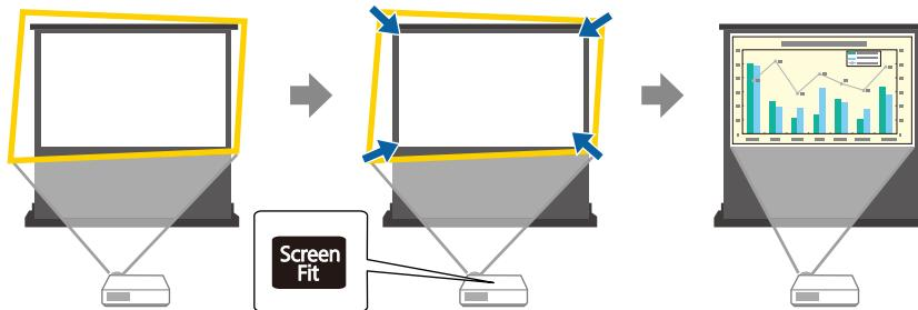
Датчик проектора может определить размер и форму экрана при таких условиях:
