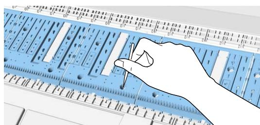
**Manutenção****Secção de absorção de tinta**
