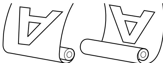
O enrolamento com o lado impresso para fora coloca a superfície impressa no exterior do rolo.
