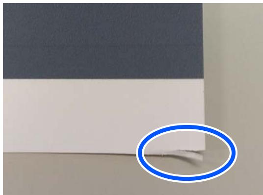
Selecione (Menu) - **Definições gerais - Definições da impressora - Def. origem do papel - Configurar papel em rolo - Definições de corte - Corte Rápido - Desactivado**.
