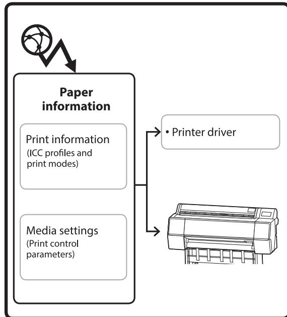
As informações de papel, incluindo perfis ICC, modos de impressão, e parâmetros de controlo de impressão, são descarregados dos servidores. As informações de papel transferidas são guardadas no controlador da impressora ou na impressora.
