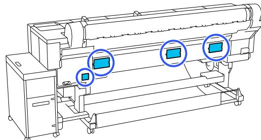
Se a impressora estiver demasiado suja, humedeça o pano em água com uma pequena quantidade de detergente neutro e, em seguida, torça-o muito bem antes de o utilizar para limpar a superfície da impressora. Em seguida, utilize um pano seco para secar a humidade restante.
