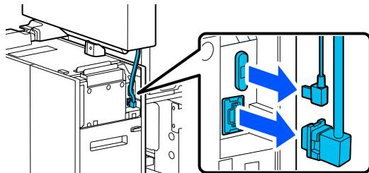
**10** Levante a alavanca do conector do tubo de tinta para a solução de tinta a granel e puxe-a para fora.
