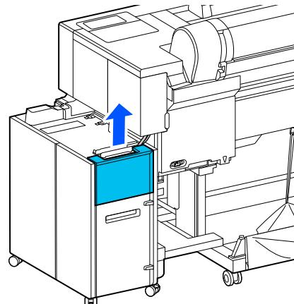
**9** Desligue os cabos da solução de tinta a granel.
