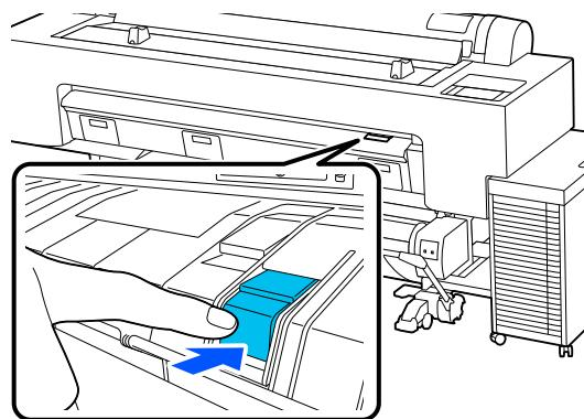
Para recolocar a peça na posição original, pressione a traseira da peça, como mostra a ilustração seguinte.
