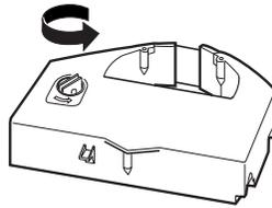
6. Halten Sie die Farbbandkassette so, dass die Stelle, an der das Farbband zu sehen ist, nach unten und der Spannkopf nach vorne zeigt.
