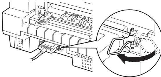
4. Schließen Sie das andere Kabelende an den parallelen Schnittstellenanschluss des Computers an.
