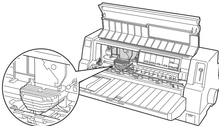
5. Nehmen Sie die neue Farbbandkassette aus der Verpackung heraus. Drehen Sie den Spannkopf in Pfeilrichtung, um das Farbband vollständig zu spannen. Hierdurch lässt es sich leichter einsetzen.
