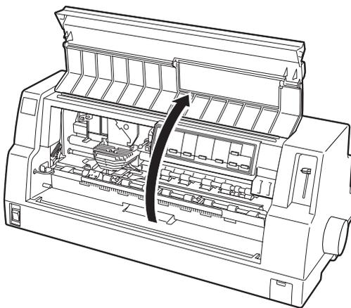
2. Schieben Sie die Papierführungsschiene der Papierführung ein kleines Stück zur Mitte. Halten Sie die Papierführung mit beiden Händen waagrecht. Schieben Sie die Aussparungen an beiden Seiten, wie in der folgenden Abbildung dargestellt, über die Montagestifte am Drucker. Senken Sie dann die Papierführung, bis diese einrastet.
