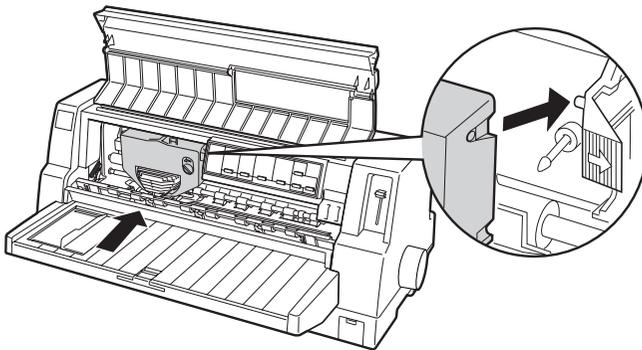
7. Drehen Sie erneut den Spannkopf, um das Farbband vollständig zu spannen, sodass es sich frei bewegen lässt.
