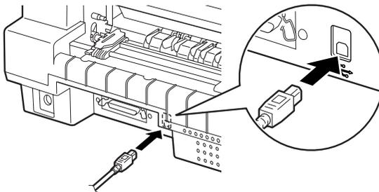
3. Schließen Sie das andere Kabelende an die USB-Schnittstelle des Computers an.
