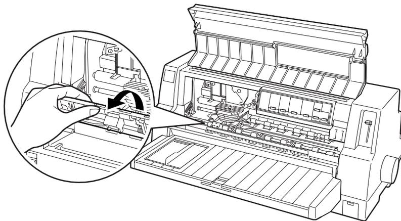
4. Schieben Sie den Druckkopf in die in der folgenden Abbildung gezeigten Position.
