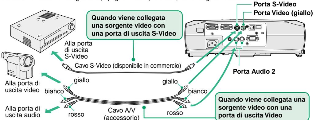
\*Per trasmettere l'audio proveniente dall'apparecchiatura video tramite l'altoparlante incorporato nel proiettore, collegare l'apparecchiatura video e il proiettore con il cavo A/V accessorio (bianco/rosso).
