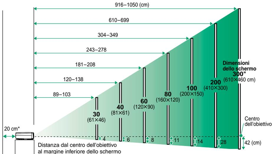
\*Con l'installazione a muro, lasciare uno spazio di circa 20 cm tra il proiettore e il muro.
