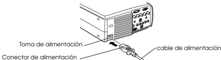
**4** Enchufe la clavija del cable de alimentación en la toma correspondiente.
