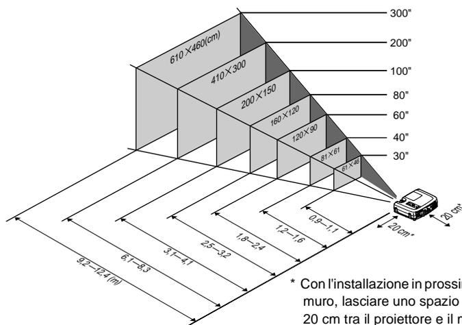
\* Con l'installazione in prossimità di un muro, lasciare uno spazio di circa 20 cm tra il proiettore e il muro.
