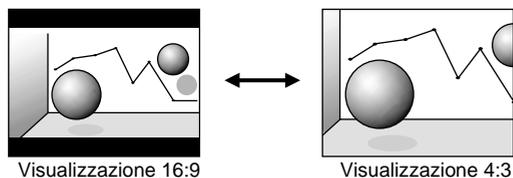
Modifica della posizione di visualizzazione per la visualizzazione 16:9. Mantenendo premuto il pulsante [Shift] del pannello di controllo del proiettore, premere il pulsante [Resize]. La posizione di visualizzazione viene modificata nel modo seguente ad ogni pressione del pulsante [Resize].
