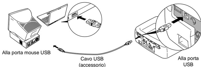
\* Se si esegue il collegamento USB, è possibile utilizzare i pulsanti [↑] e [↓] del telecomando, tramite cui è possibile scorrere le pagine in avanti e a ritroso durante la proiezione di una presentazione PowerPoint.
