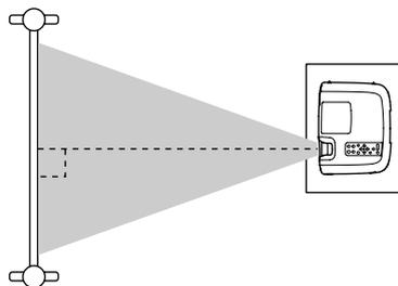
È possibile estendere o retrarre il piedino anteriore regolabile per regolare l'angolo di proiezione per un massimo di 12°.
