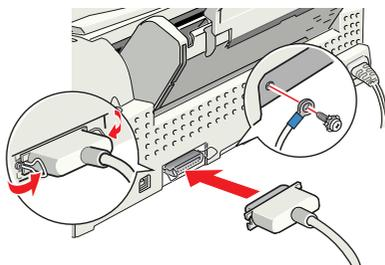
3. Conecte el otro extremo del cable al interface paralelo del ordenador. Si el cable dispone de un cable de masa en el extremo del ordenador, conéctelo al conector de masa de la parte posterior del ordenador.
