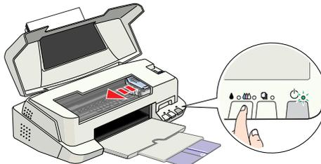
La impresora empieza a limpiar el cabezal de impresión y el indicador de alimentación
