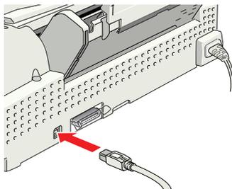
2. Conecte el otro extremo del cable al puerto USB del ordenador.
