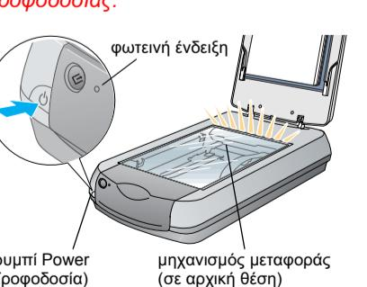
5. Ανοίξτε την ενσωματωμένη μονάδα διαφανειών για να δείτε τη λειτουργία εκκίνησης. Ενεργοποιήστε το σαρωτή πατώντας το κουμπί Power (Τροφοδοσία) Ⓞ. Ο σαρωτής τίθεται σε λειτουργία και αρχίζει να προθερμαίνεται. Η πράσινη φωτεινή ένδειξη αναβαθμίζεται μέχρι να ολοκληρωθεί η προθερμανσή. Στη συνέχεια, σταματάει να αναβαθμίζει και παραμένει πράσινη. Αυτό δηλώνει ότι ο σαρωτής είναι έτοιμος για χρήση.
