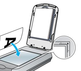
2. Πατήστε το κουμπί Start (Έναρξη) Ⓞ στο σαρωτή. Όταν ξεκινήσει αυτόματα το λογισμικό του EPSON Smart Panel, κάντε κλίκ στο εικονίδιο Scan to File (Σάρωση σε αρχείο).
