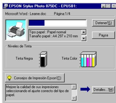
El Contador de Avance indica el progreso del trabajo de impresión actual y muestra el estado de la impresora al establecerse la comunicación bidireccional entre la impresora y el ordenador. Además ofrece consejos útiles para mejorar la impresión y muestra mensajes de error, tal como se detalla a continuación.
