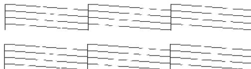
Se, no modelo de verificação, notar que faltam segmentos nas linhas de teste, poderá ter de repetir o processo de limpeza das cabeças e imprimir novamente o modelo de verificação dos jactos.
