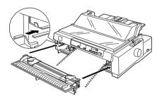
Coloque la guía del papel frontal insertándola en las ranuras laterales de la impresora, tal como se muestra en la figura anterior.
