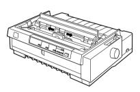
Desplace el cabezal de impresión de un lado a otro para comprobar que se desplaza sin problemas.
