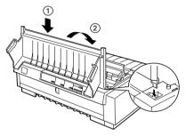
Coloque de nuevo la cubierta de la impresora y cierre la cubierta de la guía del papel.
