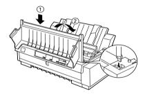
Coloque de nuevo la cubierta de la impresora y cierre la cubierta de la guía del papel.
