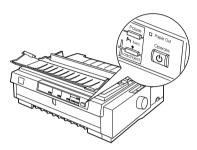
Pulse el botón Operate para desactivar la impresora (la superficie está nivelada con los protectores del botón, tal como se indica.
