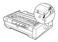
Sujete el cartucho con el mando tensor de la cinta hacia arriba. Encaje las dos muescas frontales del cartucho (①) en los pequeños anclajes situados a cada lado de la impresora, tal como se muestra en la figura. A continuación, coloque el cartucho plano para que las muescas posteriores (②) encajen en los anclajes correspondientes.
