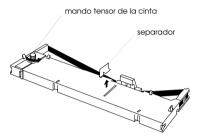
Retire el separador del nuevo cartucho de cinta y deséchelo. A continuación, gire el mando tensor de la cinta en la dirección de la flecha para tensarla.
