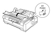
Cierre la cubierta de la guía del papel y compruebe que la palanca de liberación del papel esté colocada en la posición de tractor posterior.
