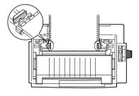
Abra las dos cubiertas de las ruedas dentadas e introduzca los tres primeros orificios del papel, con la cara imprimible hacia abajo, en los dientes del tractor. A continuación, cierre las cubiertas.
