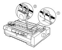
Levante la guía de la cinta (①) e insértela firmemente en las clavijas de metal (②) situadas detrás del cabezal de impresión. Compruebe que la cinta no esté doblada o arrugada y que se encuentre en su posición, detrás del cabezal de impresión. A continuación, presione la guía de la cinta hasta que encaje en su posición con un clic.
