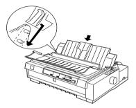
Instale la guía del papel, levante la sección central de dicha guía y colóquela plana.
