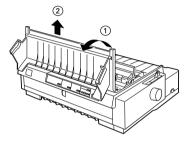
Abra la cubierta de la guía del papel, levante la cubierta de la impresora por su borde posterior y extráigala tirando de ella hacia arriba.
