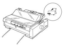
Cierre la guía del papel frontal y compruebe que la palanca de liberación del papel esté colocada en la posición de tractor frontal.
