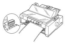
Abra las dos cubiertas de las ruedas dentadas e introduzca los tres primeros orificios del papel, con la cara imprimible hacia arriba, en los dientes del tractor. A continuación, cierre las cubiertas.
