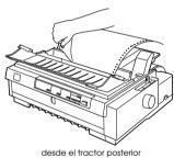
Abra la cubierta de la guía del papel y corte el documento impreso con el borde de corte de la impresora.
