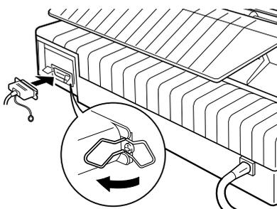
3. Si votre câble est muni d'un fil de masse, raccordez ce dernier au connecteur de masse de l'imprimante, de la manière indiquée ci-dessous.
