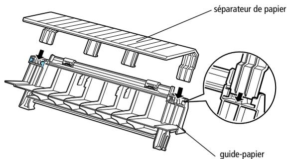
2. Assurez-vous que le capot du guide-papier est ouvert de la manière illustrée. Fixez le guide-papier en faisant glisser les orifices, situés au bas du guide-papier, par-dessus les pattes qui se trouvent derrière l'unité de tension du papier.
