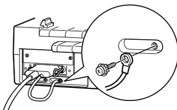
4. Enfichez l'autre extrémité du câble sur l'ordinateur. (Si ce câble est muni d'un fil de masse, raccordez-le au connecteur de masse situé à l'arrière de l'ordinateur.)
