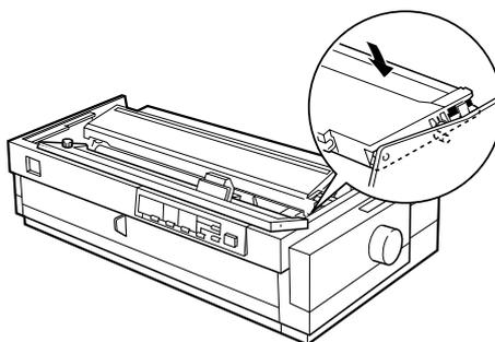
8. Soulevez le guide-ruban de la cassette (①) et insérez-le fermement par-dessus les broches métalliques situées derrière la tête d'impression(②). Assurez-vous que le ruban n'est pas tordu ou froissé et qu'il se trouve bien derrière la tête d'impression. Abaissez délicatement le guide jusqu'à ce qu'il émette un déclic.
