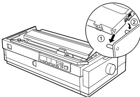
7. Assurez-vous que les deux entailles, à l'arrière de la cassette, sont bien posées par-dessus les petites pattes situées de part et d'autre de l'imprimante. Appuyez ensuite délicatement sur la cassette jusqu'à ce que les deux extrémités se verrouillent en émettant un déclic.
