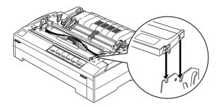
8. En vous aidant d'un objet pointu comme un stylo à bille, faites passer le ruban entre la tête d'impression et le guide du ruban. Tournez la molette de tension du ruban pour faciliter la mise en place de ce dernier. Il ne doit être ni torsadé, ni froissé.
