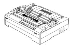
10. Réinstallez l'unité de tension du papier en le plaçant sur les pattes de montage de l'imprimante puis en l'enfonçant. Appuyez sur les deux côtés du dispositif jusqu'à ce qu'un déclic soit audible.
