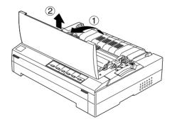
4. Appuyez sur les pattes situées de chaque côté de l'unité de tension du papier, puis soulevez l'avant du dispositif et retirez-le de l'imprimante.
