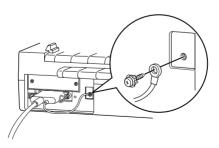
4. Insérez le connecteur de l'autre extrémité du câble dans le port d'interface parallèle de l'ordinateur (si l'extrémité du câble est munie d'un fil de terre, reliez-le au connecteur de terre situé à l'arrière de l'ordinateur).
