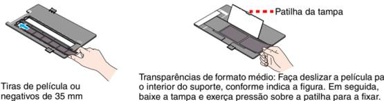
Se estiver a digitalizar slides, primeiro coloque o suporte no digitalizador e, em seguida, insira os slides no suporte, tal como é indicado no final da folha.
