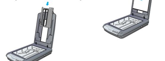
3 Volte a instalar a cobertura reflectora.
