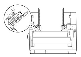
Abra ambas as tampas da correia de tracção e insira os três primeiros orifícios do papel nos pinos do tractor, com a face a ser impressa voltada para baixo. Em seguida, feche as tampas da correia de tracção.
