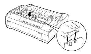
Segure na cassete de fita pela pega e insira-a na impressora exercendo pressão. Em seguida, pressione as extremidades da cassete para que os ganchos plásticos encaixem nas ranhuras.
