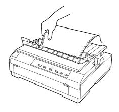
Abra a tampa do guia da trajectória de papel e corte o documento impresso utilizando a aresta de corte da impressora.
