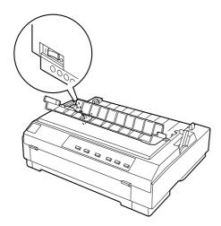
Desligue a impressora. O interruptor de funcionamento está situado no lado esquerdo da impressora.
