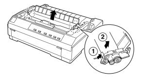
Levante as patilhas existentes em ambos os lados do tensor de papel, levante o tensor e e retire-o da impressora. Guarde o tensor de papel num local seguro. Quando o tractor posterior estiver instalado, não tem de retirar o tensor de papel. **5**
