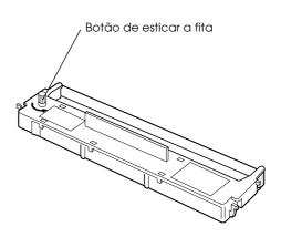
Retire a nova cassete de fita da embalagem. Rode o botão de esticar a fita na direcção indicada pela seta para eliminar a folga existente na fita.
