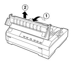
Abra a tampa do suporte de admissão do papel. Em seguida, levante a tampa da impressora pela parte posterior e retire-a da impressora.
