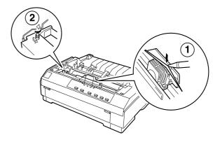
Utilize um objecto pontiagudo, por exemplo, o bico de uma esferográfica, para colocar a fita entre a cabeça de impressão e o guia de fita. Rode o botão de esticar a fita para conseguir colocar facilmente a fita na posição correcta.
