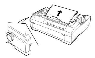
Rode o punho situado do lado esquerdo da impressora para a frente, para ejectar o papel da impressora. Retire todos os pedaços de papel.
