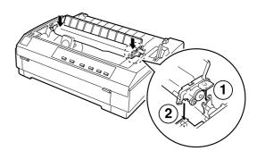
Para voltar a instalar o tensor de papel, encaixe-o nos pinos da impressora. Em seguida, exerça pressão em ambas as extremidades do tensor de papel até o fixar.
